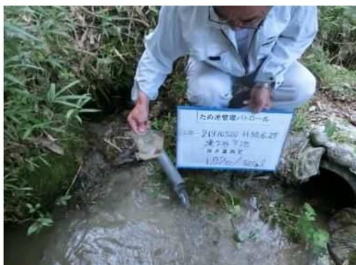
後法 漏水量測定(遠景)
