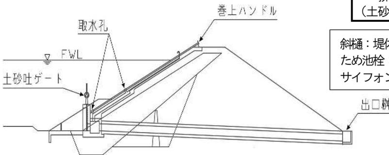
斜樋：堤体法面に設置し、上部のハンドルで操作
