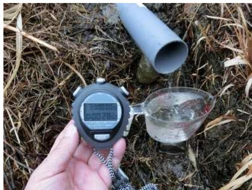
後法 漏水量測定(近景)
