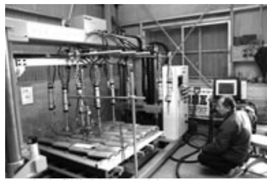
▲瓦引き上げ性能試験機による試験
