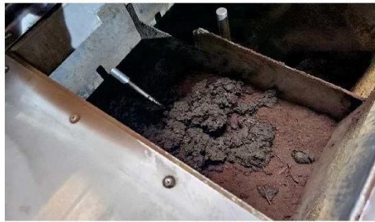
写真10. 下水汚泥脱水品投入
