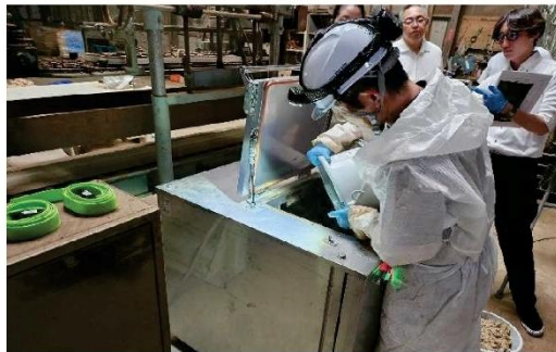
写真9. 下水汚泥脱水品投入
