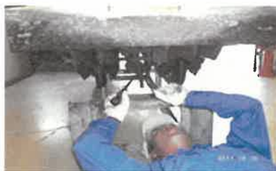
◆炉内台車車軸交換
