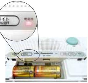
戸別受信機には乾電池ランプがあり、電池が消耗していき、入っている電池の色が赤色で点滅します。交換方法は取扱説明書をご覧ください。なお、乾電池代は個人等でご負担をお願いします。
