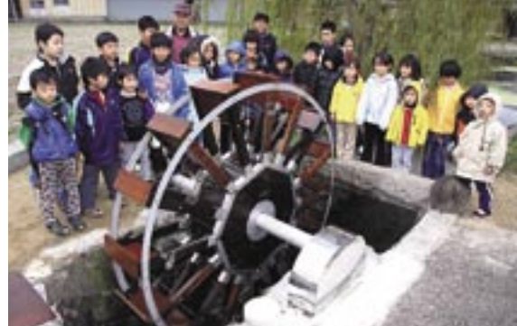
▲回転で取り付けた電球も光る水車。電気ケーブルを巻く樽の廃材を利用し、ステンレス材で補強しています
