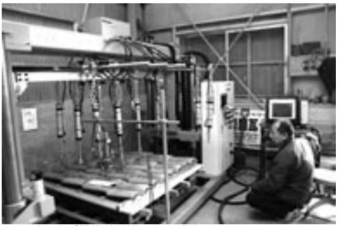
▲瓦引き上げ性能試験機による試験
