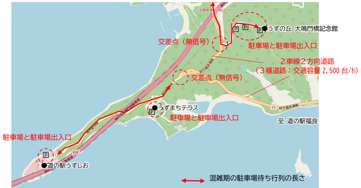
混雑時に自動車交通のボトルネックとなり得る箇所
