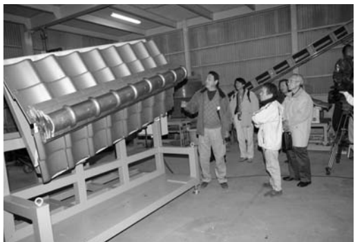
▼屋根瓦の耐震性を調べる棟回転 加速度試験機
