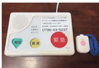
▲緊急通報システム
