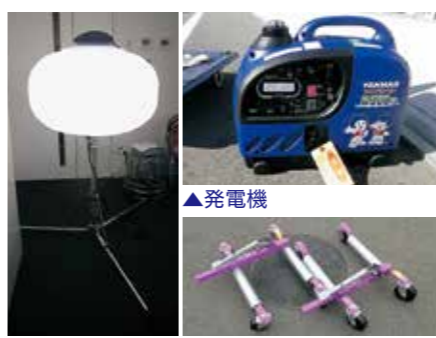
▲投光器 ▲発電機 ▲簡易車両移動装置
